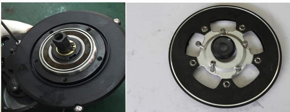
图示 1-3 主体及牙盘组件 Figure 1-3 Main body and Chain wheel
